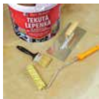
8 / Készítse elő a szerszámokat: hengert, ecsetet vagy acélsimítót.
