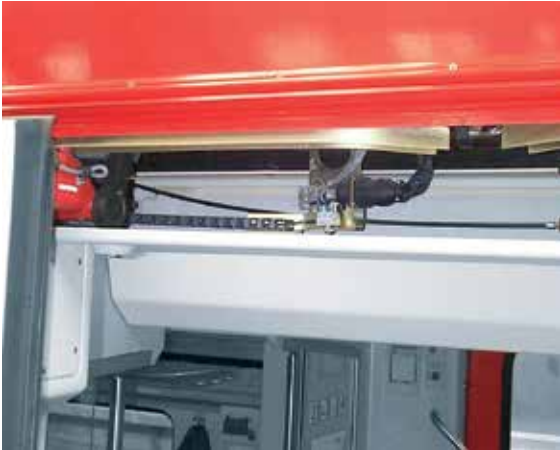
E2 mini e-chain® in a tooling machine, coolant resistant
