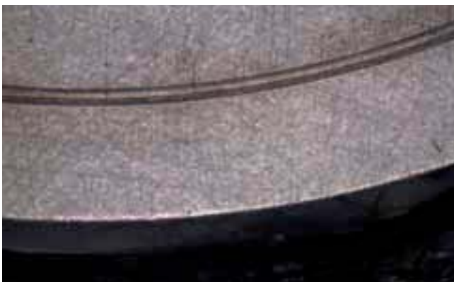
Einlaufrille nach 24 Stunden Run-in groove after 24 hours
