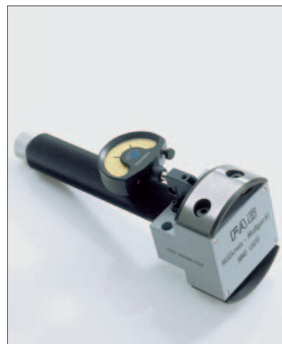
FAG MGI 21 burkolókör-mérőműszer a radiális csapágyhézag ill. a lehúzható belső gyűrűvel rendelkező hengergörgős csapágyak előfeszítettségének beállításához
