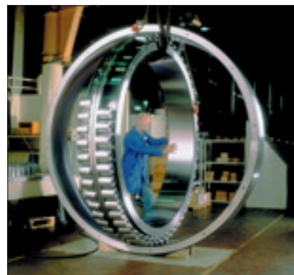
Nagyméretű csapágy szerelése
