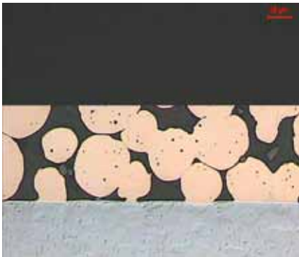
Abb. 9: Zustand der Gleitfläche am Ende der Lebensdauer
