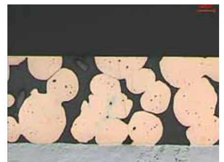
Abb. 8: Zustand der Gleitfläche innerhalb der Lebensdauer
