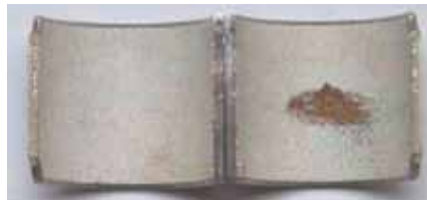
Abb 34: Örtlicher Schaden durch Kavitation
